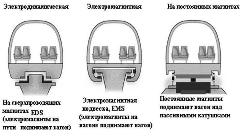
Рис. 2. Разновидности технологии работы Маглев
