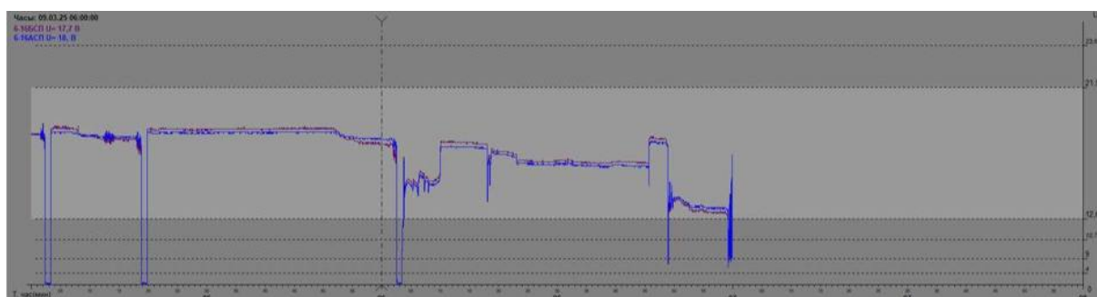
Рис. 2. График anomального изменения колебания напряжения (в пределах нормы) на рельсовой цепи
