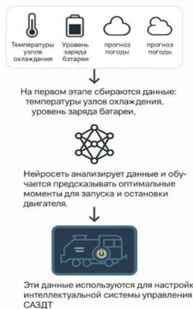
Рис. 1. Принцип работы системы автоматического запуска тепловоза
