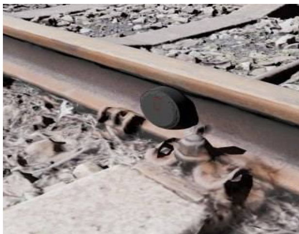
Рис. 3. Способ прикрепления ГЛОНАСС-маячка на шейку инвентарного рельса
