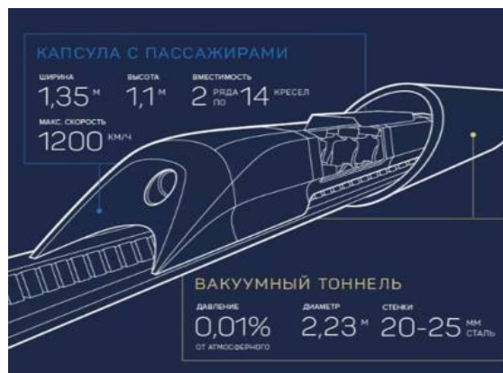
Рис. 4. Hyperloop-платформа, основанная на технологии рельсотронного ускорителя
