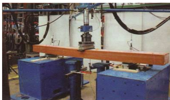
Рис. 6. Способ тестирования композитных шпал
